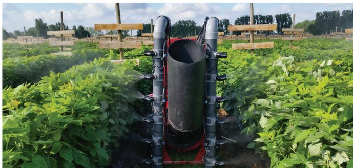
Die einzigartige Antriebs- und Luftversorgung ist die Lösung von Hardi, die maximale Lufteffizienz und minimalen Verschleiß gewährleistet. Der Antrieb vom Traktor zum Gebläse erfolgt direkt über ein 2-Gang-Getriebe. Die höchste erzeugte Luftmenge auf dem Markt bei geringstem Energiebedarf. Die optionale Saugdüse aus Kunststoff verhindert, dass das Gebläse Blätter vom Boden aufsaugt. Dies gewährleistet saubere Luft für die Steuerung der Flüssigkeit.
